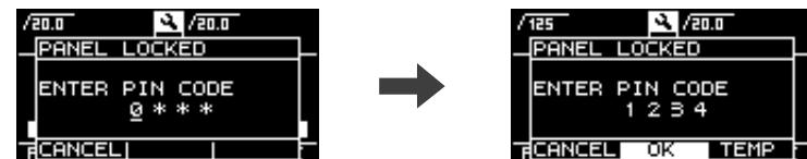
Чтобы снять блокировку панели, введите PIN-код, поворачивая основной регулятор, выберите OK, затем нажмите основной регулятор.
