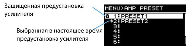
Выберите номер предустановки усилителя, повернув основной регулятор и нажав его. Отображается экран выбора последовательности действий.
