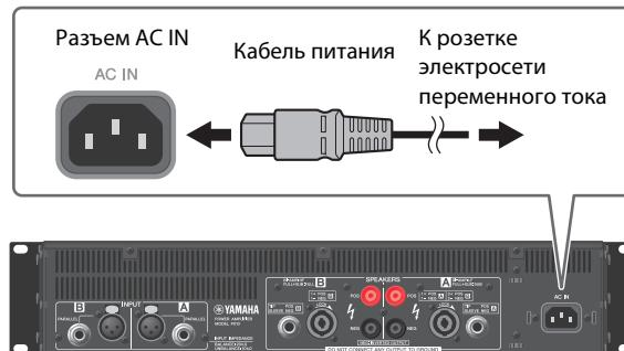
Надежно закрепите кабель питания переменного тока с помощью фиксатора штекера для предотвращения случайного отсоединения кабеля от розетки.
