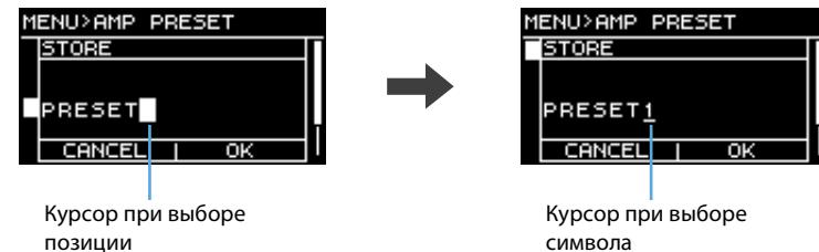
Поворачивайте основной регулятор для выбора позиции ввода символа и нажимайте основной регулятор для перехода к вводу символа. Затем поворачивайте основной регулятор для выбора символа ввода и нажимайте основной регулятор для фактического ввода символа.
