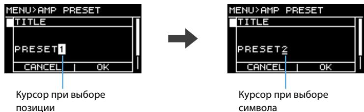
Поворачивайте основной регулятор для выбора позиции ввода символа и нажимайте основной регулятор для перехода к вводу символа. Затем поворачивайте основной регулятор для выбора символа ввода и нажимайте основной регулятор для фактического ввода символа.
