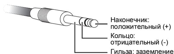
Присоедините стандартные кабели с монофоническими разъемами для наушников к разъемам для наушников на динамике HS, предназначенным для несбалансированных соединений.
